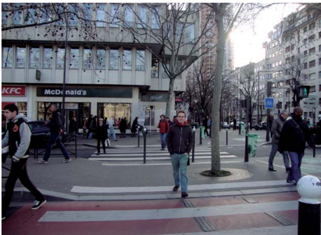
Faixa de pedestre com rebaixamento de meio-fio. Paris, França. 2011. Foto: Sandra Bernardes Ribeiro.
